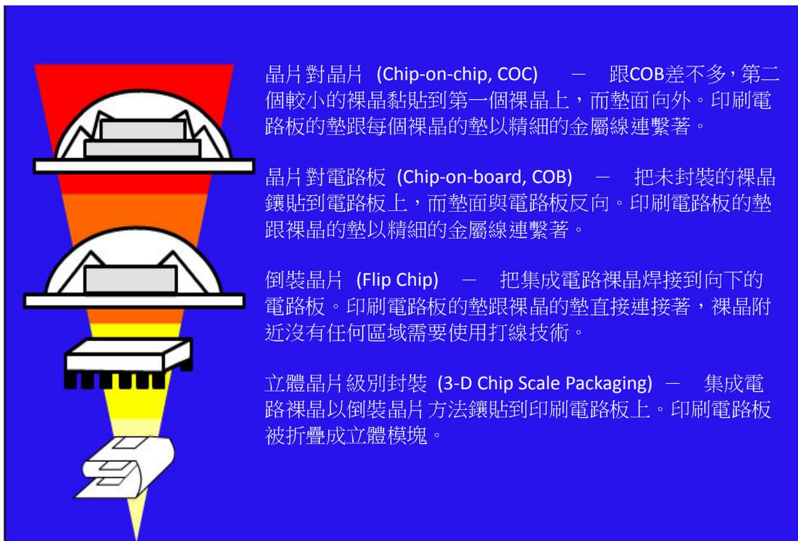
**晶片對晶片 (Chip-on-chip, COC)** — 跟COB差不多，第二個較小的裸晶黏貼到第一個裸晶上，而墊面向外。印刷電路板的墊跟每個裸晶的墊以精細的金屬線連繫著。
