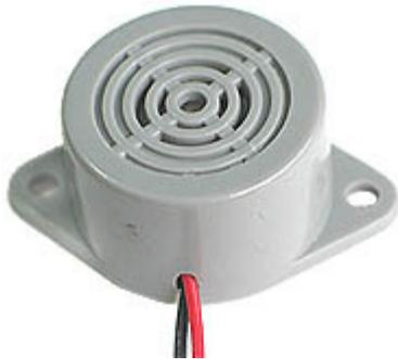
一般來說，**蜂鳴器**就像一個揚聲器，它以電聲信號來發聲。唯一不同的是，以壓電 (pizeo-electric) 製造的蜂鳴器，是由電壓驅動的，而揚聲器是由線圈造成的電流驅動的裝置。
