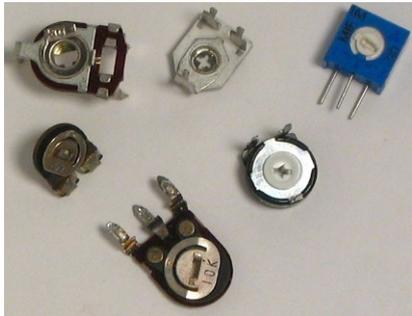
**電位器**是一個可變電阻器，它可以用作分壓器。最常見的用途就是用作聲頻控制裝置。
